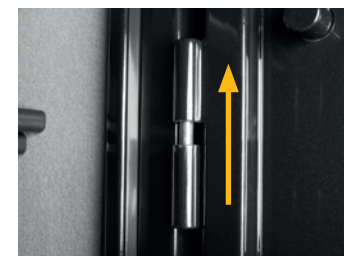
Figure 1. La porte doit être libérée de l'encadrement pour pouvoir être retirée. Soulevez bien droit pour éviter d'endommager les tenons.
